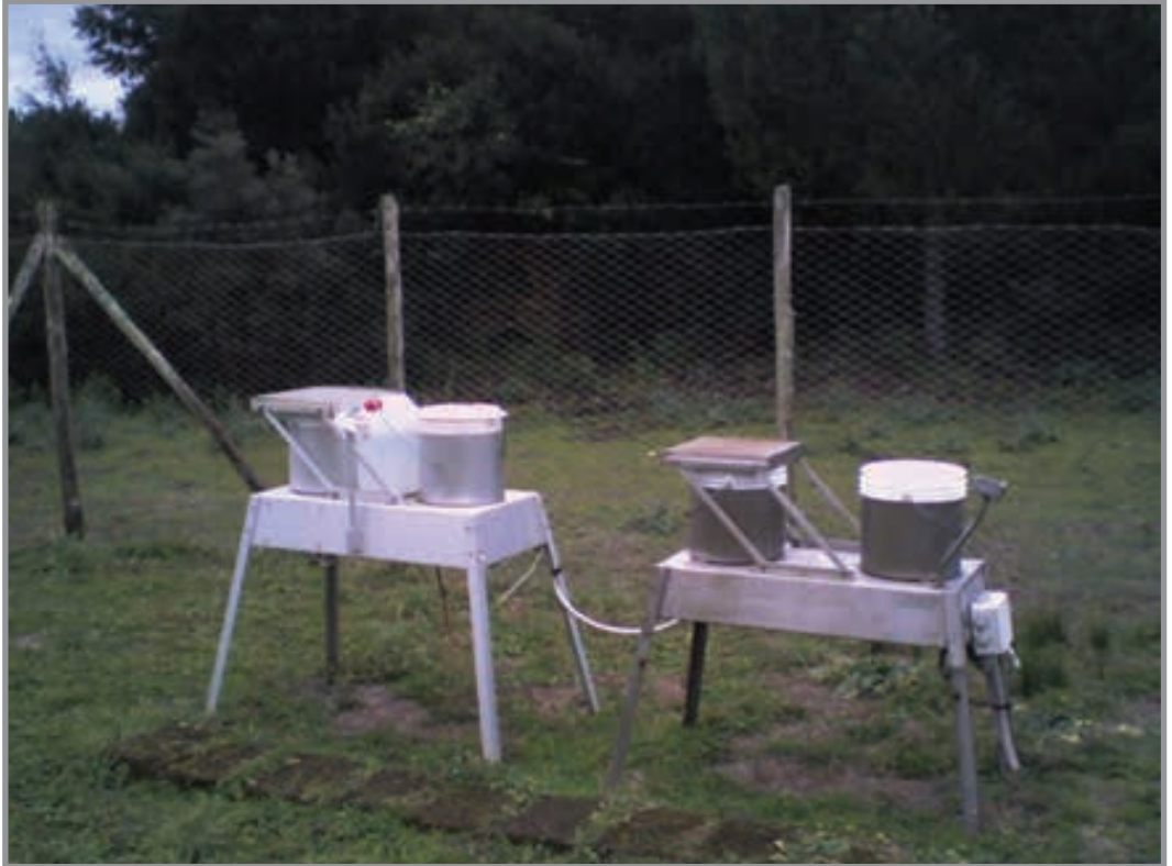
Fig. 6 - Campionatori per le deposizioni atmosferiche tipo DDAS e Wet&Dry installati in località Tor Paterno.
